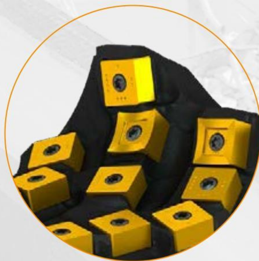
立装可转位刀片 具有更高厚度和IC值的刀片具有更好的刚性。使用PVD材质(7310和M8310)同时有助于提升了可靠性。刀夹中所有刀片座(11个)使用的平板刀片(S-SNEX 15-2462000)具有8个切削刃, 用于执行粗加工作业, 每个刀夹的11个刀片座中有9个用于执行精加工作业, 刀片座9和10中的圆刀片具有4个切削刃(刀片类型取决于所加工的钢轨类型)仅用于精加工。
