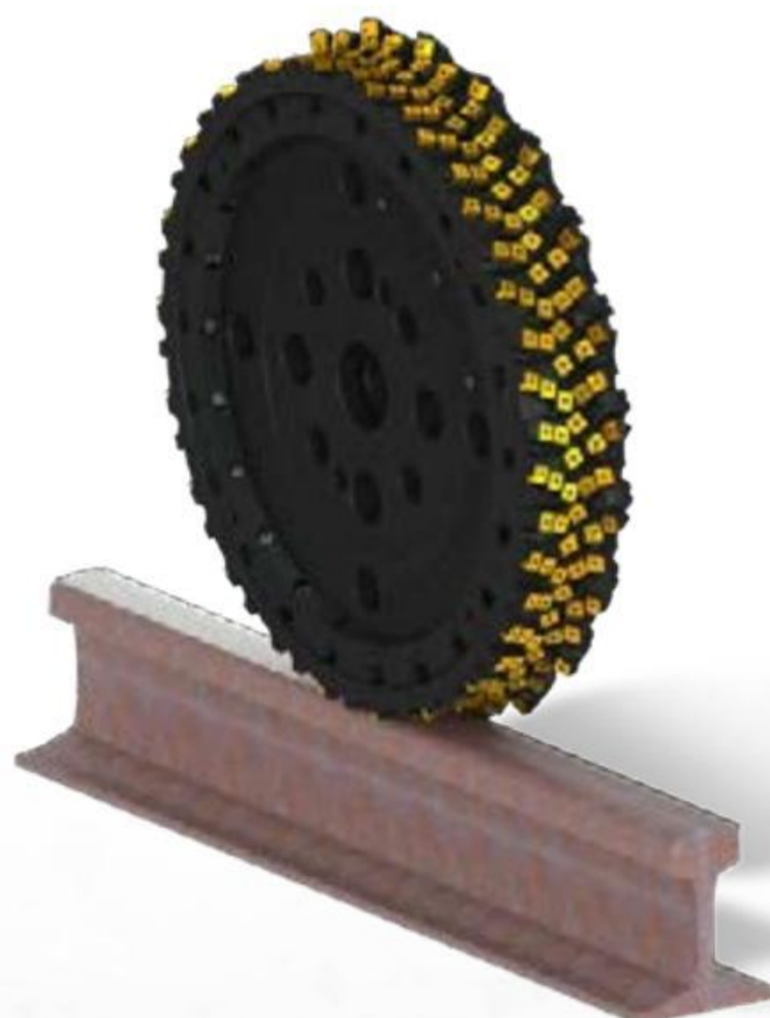
ø600mm动态钢轨铣刀 用于钢轨加工的铣刀, 包含通用基体和22个易互换的刀夹, 由3个螺钉锁紧, 每个刀夹包含11个可转位刀片。共计242个刀片。切削轮廓由所使用的刀夹决定。可根据需要提供用于60E1、60E2、54E5、54E1、46E3和其他钢轨类型的刀夹。铣刀适用于Linsinger铣床。
