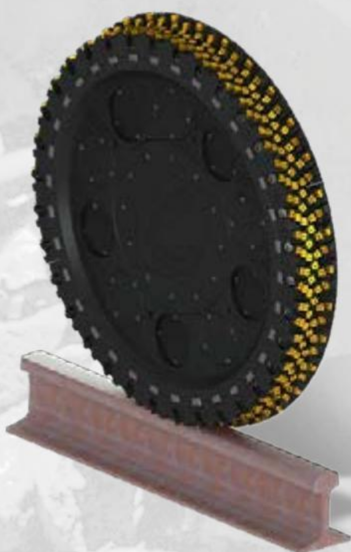
ø900mm动态钢轨铣刀 用于钢轨加工的铣刀, 包含通用基体和34个易互换的刀夹, 刀夹用一个螺钉锁紧, 每个刀夹包含11个可转位刀片。共计374个刀片。切削轮廓由所使用的刀夹决定。可根据要求提供适用于60 TBT和其他钢轨类型的刀夹。
