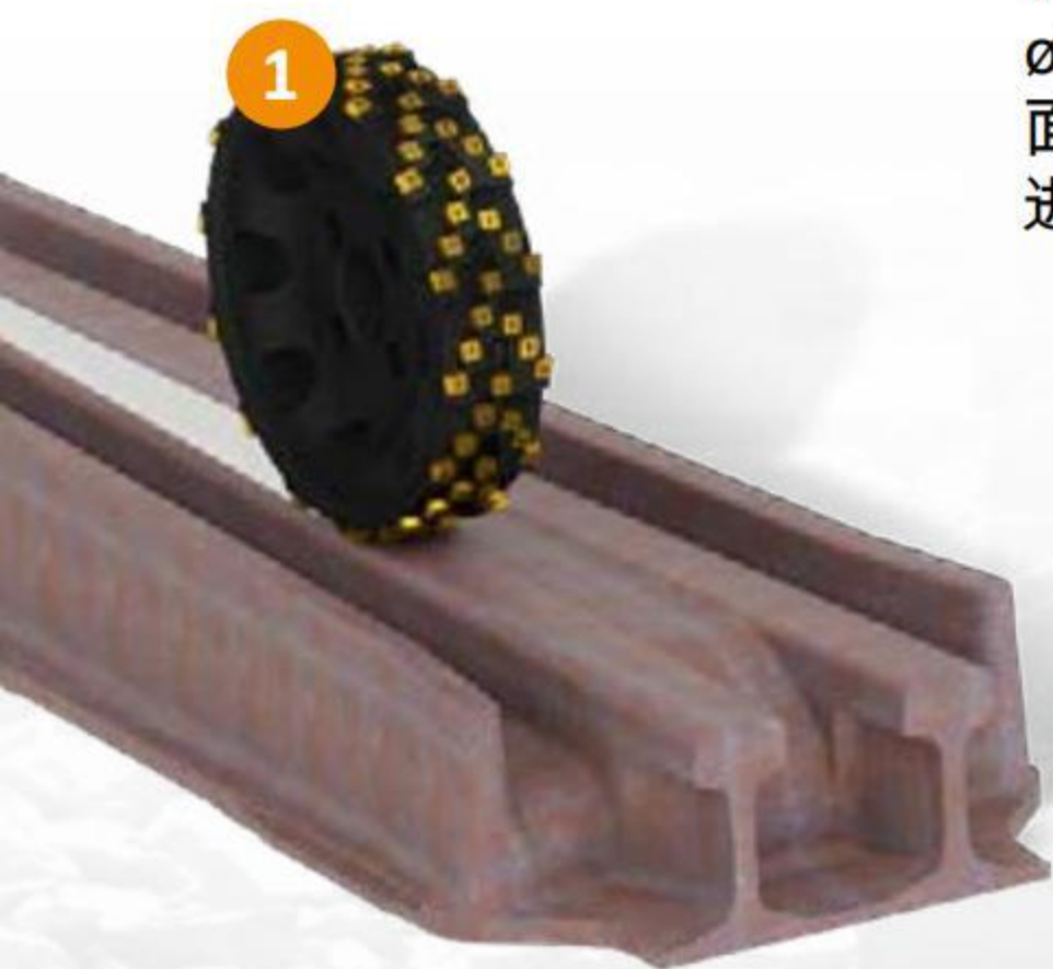
2 – 用于翼轨加工的凹型铣刀 最大 \phi 340\text{mm} , 具有非常宽的切削区域, 用于铣削圆角半径 (R13)、顶部半径 (R80、R300) 和两个斜面 (1:20, 1:10)。
